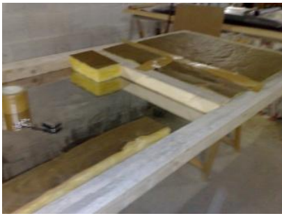
Cadre en bois, Tôle inox 8/10 et isolant pour l'arrière des panneaux
